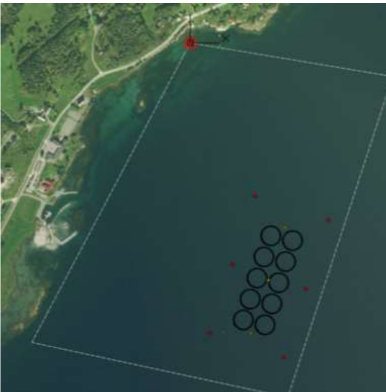
Figur 6 viser illustrasjon av plassering av 10 merder og markeringsbøyer og fortøyningsbøyer med blinkere. (Grimstad og Tønsager AS/Kystbygg AS).
